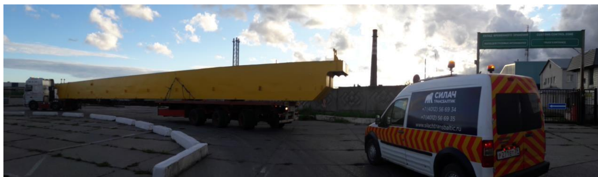
Пролётные балки мостового крана (33*2*2м)
